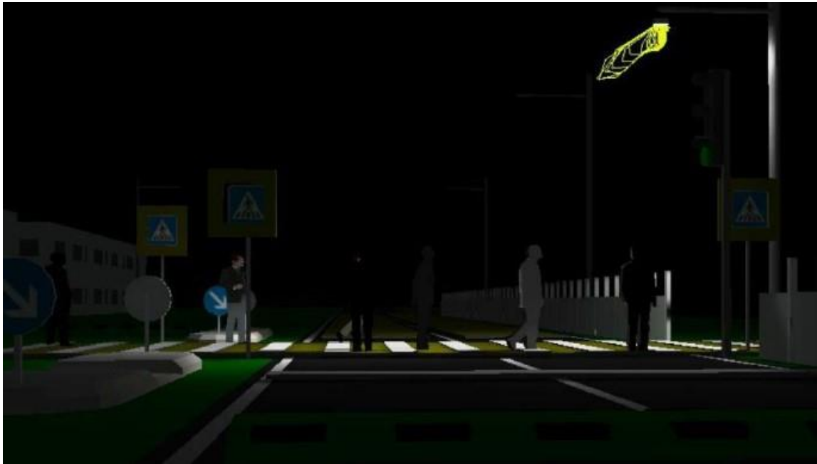
Рисунок 3.17.4 – Пример неправильного освещения пешеходного перехода
