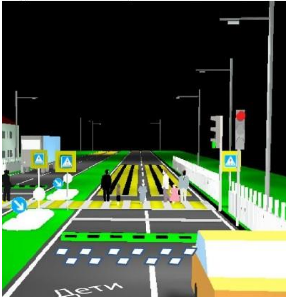
Рисунок 3.17.5 – Пример правильно освещенного пешеходного перехода. Стоп-линия. Лежащий полицейский. Предупреждающая надпись
